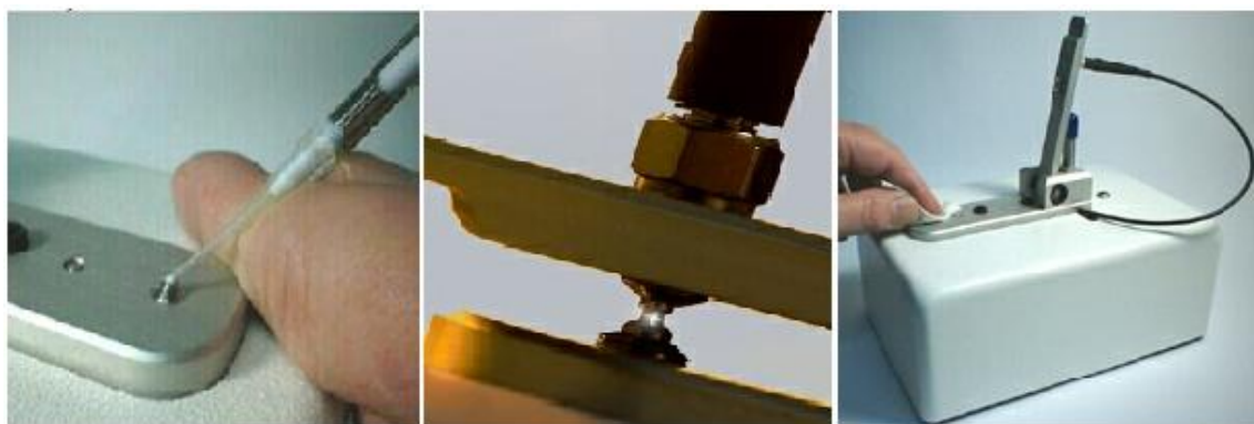
Σχήμα 4.3: Χειρισμός του Nanodrop: α) τοποθέτηση με πιπέτα 0,5-2,5 μL στην οπή β) Θέση βραχίονα κατά την μέτρηση της απορρόφησης γ) Καθαρισμός της θέσης μετά την μέτρηση.
