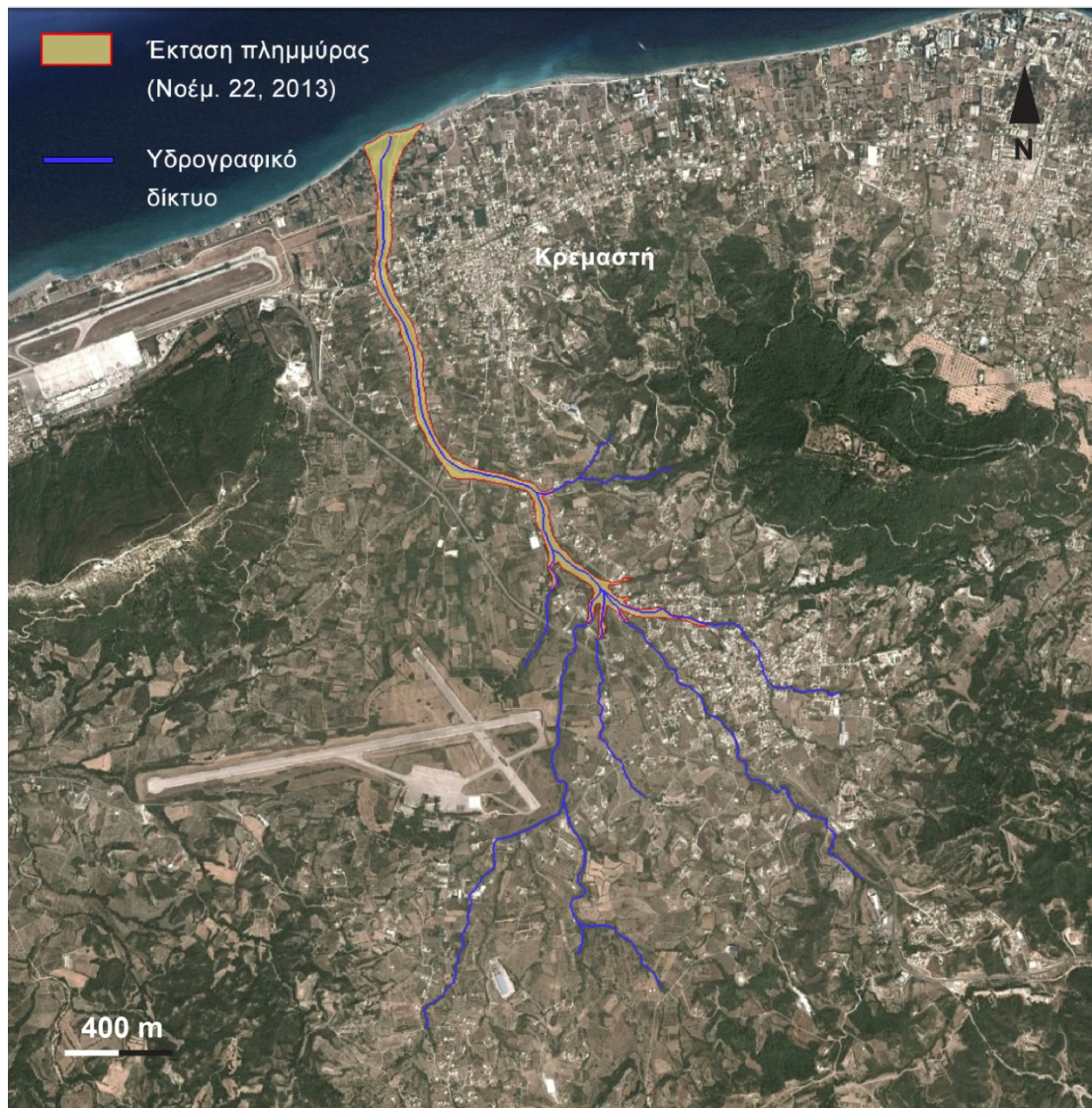
Εικ. 6. 18 Αποτύπωση της έκτασης της πλημμύρας στον οικισμό της Κρεμαστής στην αντίστοιχη υδρολογική λεκάνη.
