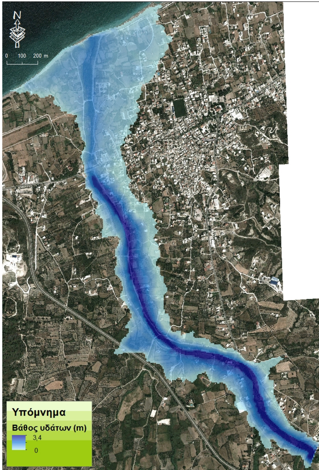
Εικ. 7. 8 Όρια κατάκλυσης των πλημμυρών των 50 ετών και βάθος πλημμυρικών υδάτων για το σενάριο της πλημμύρας των 50 ετών στη λεκάνη της Κρεμαστής (πάνω σε γεωαναφερμένη εικόνα από Google earth).
