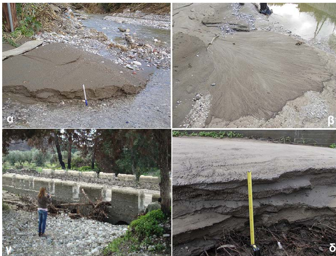
Εικ. 4. 6 Εδαφικό υλικό που αποτέθηκε κατά τη διάρκεια της πλημμύρας σε διάφορες θέσεις παραπλεύρως της κοίτης. Στην περίπτωση της εικόνας (γ) τα φερτά υλικά έχουν μειώσει την παροχευτική δυνατότητα των αγωγών.
