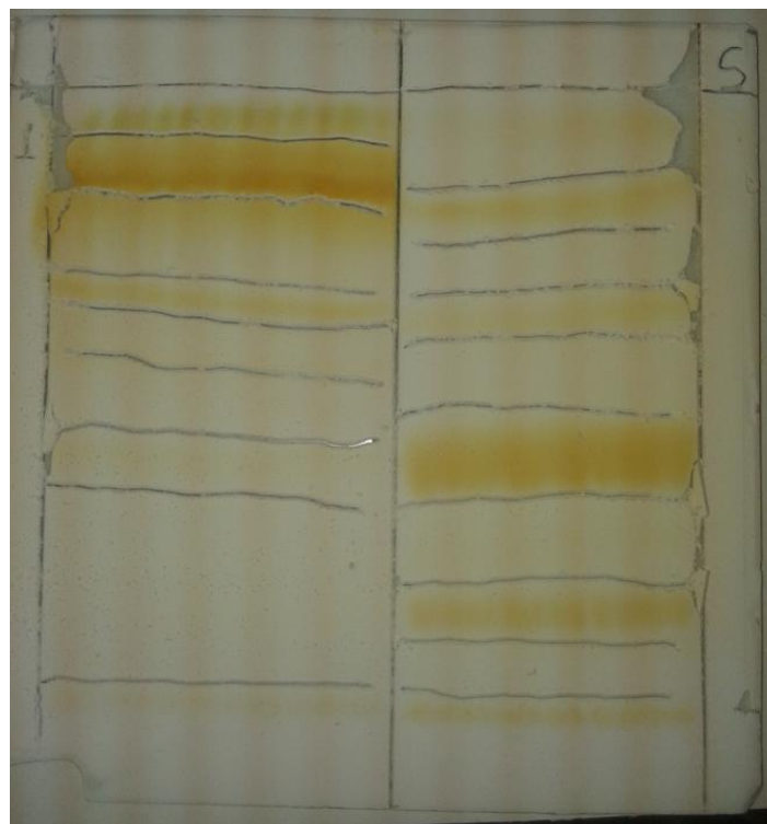
Εικόνα Β: Χρωματογραφική Πλάκα μετά από TLC. Πρώτη στήλη: TPL Ελαιοπυρήνα, Δεύτερη στήλη: Πρότυπο δείγμα λιποειδών από στούκι
