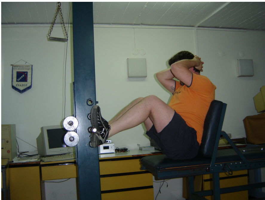
ΕΙΚΟΝΑ 3-5. Μέτρηση σε ηλεκτρικό δυναμόμετρο εντός σιδερένιας μπάρας υπερνίκησης εξωτερικής αντίστασης κάτω άκρων (όργανο του ΕΚΑΕ).
