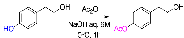
Σχήμα 23. Εκλεκτική ακετυλίωση φαινολικού υδροξυλίου τυροσόλης
