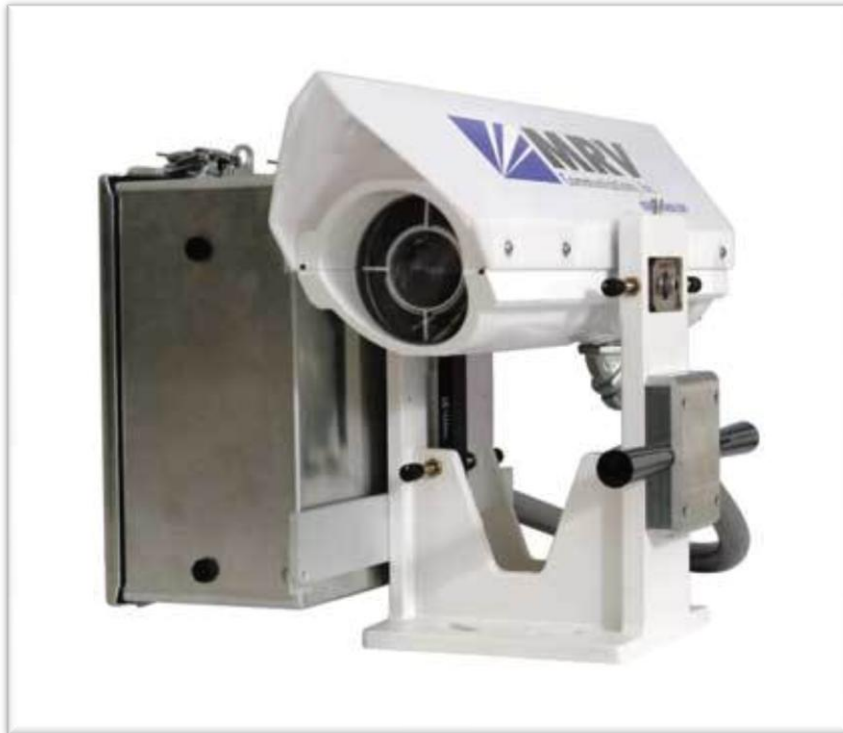
Σχήμα 1.1 Υβριδικό σύστημα FSO/RF που χρησιμοποιεί ραδιοσυχνότητες σε περίπτωση πυκνής ομίχλης [7]
