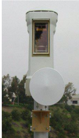
Σχήμα 2.6 Πρωτότυπο Σύστημα HFR. Το παραβολικό πιάτο έχει 13 ίντσες διάμετρο. [9]
