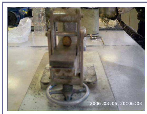
Εικόνα 3.7: Θέση στην οποία τοποθετείται το pellet για τη μέτρηση του ορίου θραύσης.
