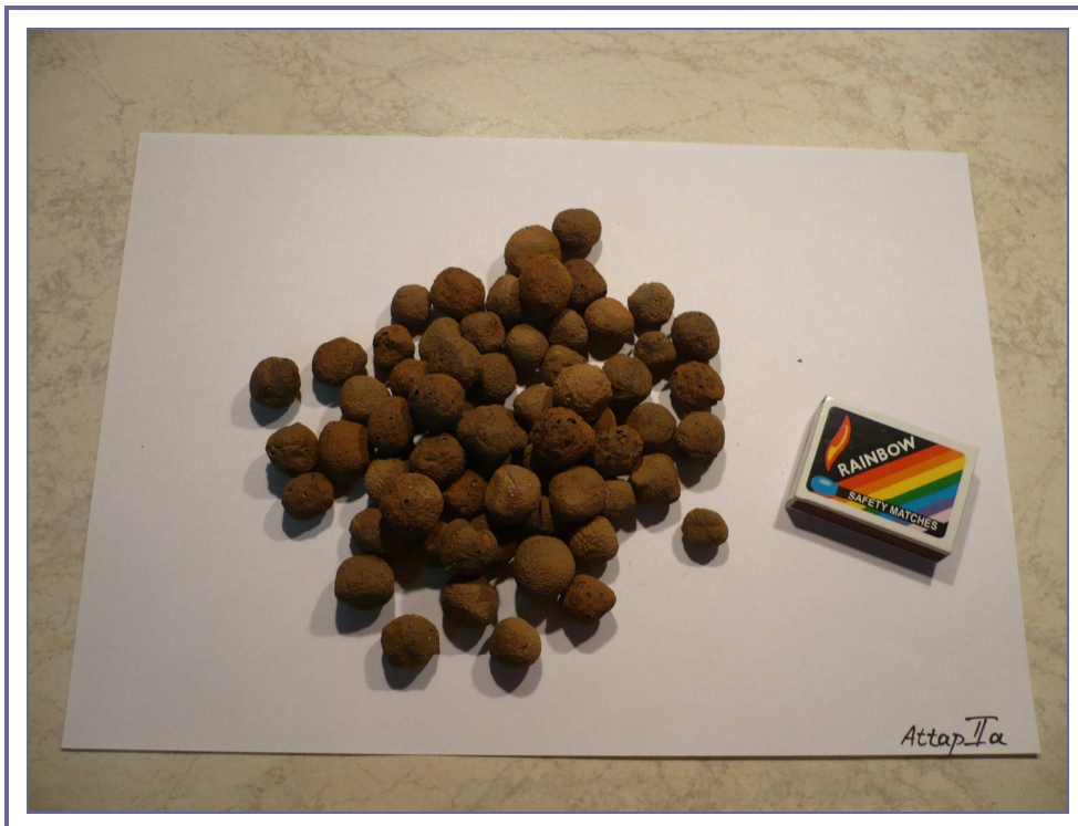
Εικόνα 3.4: Δείγματα μετά την επεξεργασία του υλικού. Attap I, Attap II με πριονίδι 5%, Attap Ia, Attap IIa με πριονίδι 12%.
