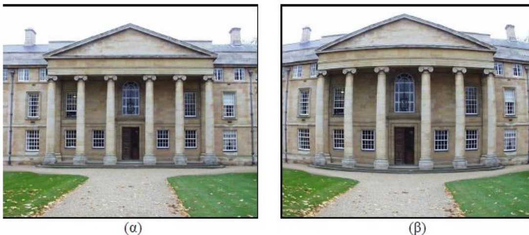
Εικόνα 2.6: Παράδειγμα ακτινικής παραμόρφωσης (α) εικόνα χωρίς παραμόρφωση, (β) εικόνα με ακτινική παραμόρφωση τύπου barrel. Τα σημεία της εικόνας έχουν μετατοπιστεί ακτινικά ως το κέντρο της εικόνας.
