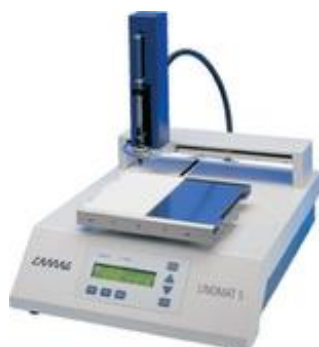
Εικόνα B.16: Σύστημα CAMAG Linomat 5 με σύριγγα για την ομοιόμορφη εφαρμογή των δειγμάτων στις πλάκες με τη μορφή ψεκασμού
