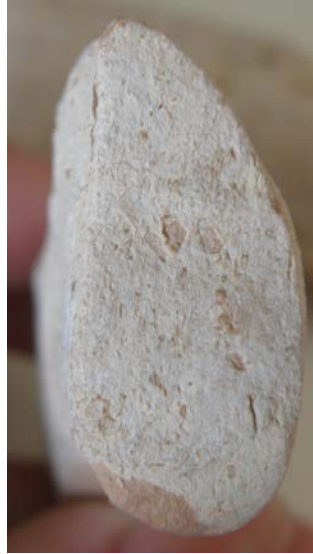
Φωτ. 3.4: Τομή σπείρας δείγματος EAN204, η οποία έχει διαβρωθεί σχεδόν κατά το ήμισυ.
