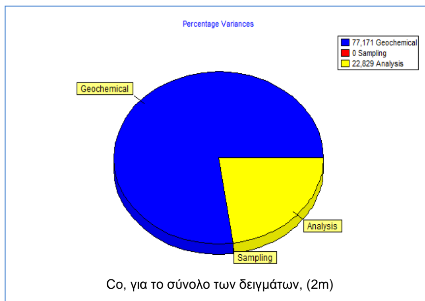
Σχήμα 4: Αποτελέσματα της παραμετρικής ανάλυσης της διακύμανσης των μετρήσεων με βάση τα διπλά δείγματα Co στα 2m για το σύνολο των δειγμάτων στις δύο παιδικές χαρές, με χρήση ευσταθών στατιστικών
