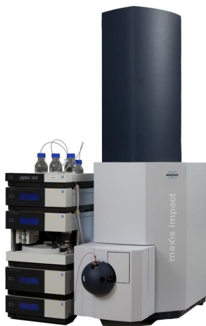
Εικόνα 2: Υγροχρωματογραφικό σύστημα με ανιχνευτή υβριδικό αναλυτή μαζών τετραπόλου-χρόνου πτήσης (LC-MS/MS) της Bruker Maxis Impact
