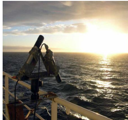
Εικόνα III-5. Ραδιόμετρο μέτρησης SST
