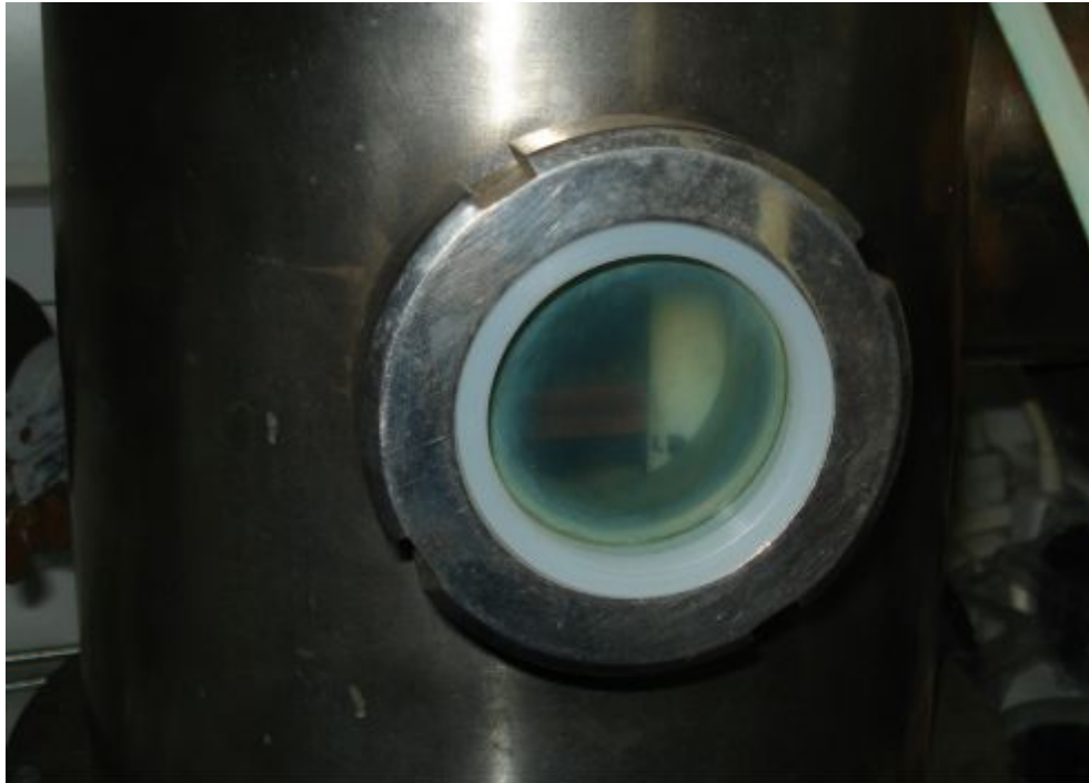
Εικόνα 1-9: Παράθυρο παρακολούθησης του εσωτερικού του θαλάμου.
