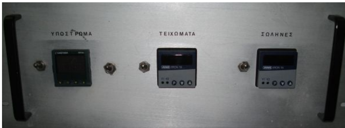
Εικόνα 1-10: Κονσόλα ελέγχου και καθορισμού της θερμοκρασίας.
