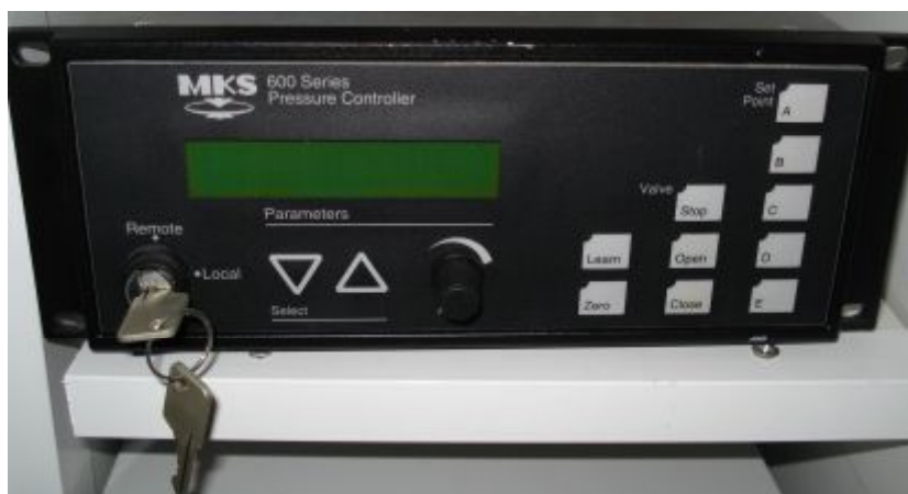
Εικόνα 1-11: Ηλεκτρονικό μανόμετρο καθορισμού και μέτρησης πίεσης.
