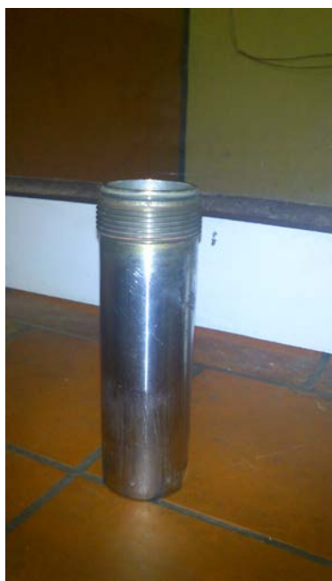
Εικόνα 3: Μεταλλικό δοχείο αντιδραστήρα
