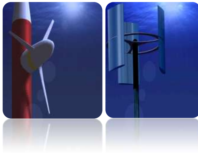
Εικόνα 2-22: Στρόβιλος οριζόντιου άξονα (αριστερά) και κάθετου άξονα (δεξιά). (Πηγή: http://www.strath.ac.uk/ )
