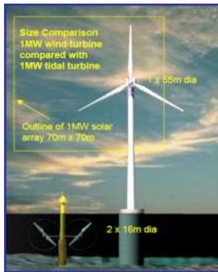
Εικόνα 2-20: Σχηματική σύγκριση της ισχύος των ρευμάτων με την αιολική και την ηλιακή, σε σχέση με την επιφάνεια που καταλαμβάνει η κάθε τεχνολογία [Fraenkel, 2004].
