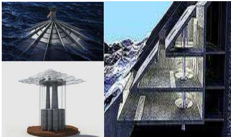
Εικόνα 2-5: Απεικόνιση πλωτής και σταθερής εγκατάστασης μετατροπέα SSG.
