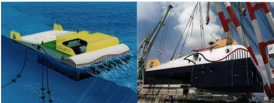
Εικόνα 2-12: Σχηματική αναπαράσταση του μετατροπέα Mighty Whale και κατέλκυση στο Gokasho Bay το 1998.
