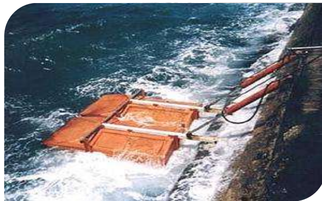
Εικόνα 2-7: Εγκατεστημένο μοντέλο SDE στο Ισραήλ. Το περύγιο εκτελεί ανοδική-καθοδική κίνηση για την παραγωγή ενέργειας.
