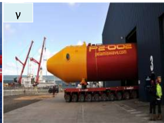
Εικόνα 2-17: α) Περιγραφή λειτουργίας Pelamis β) Κυματική φάρμα στην Agucadoura γ) Έτοιμο τμήμα μονάδας Pelamis, μεταφέρεται από το εργοστάσιο στην προκυμαία με ειδικό όχημα SPMT (Self-Propelled Modular Transporter), (Πηγή: www.pelamiswave.com ).
