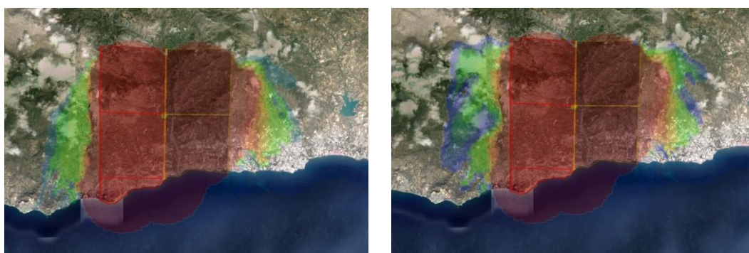
Εικόνα 5.4: Οπτικοποίηση της εξόδου του FLogA στο 90ο λεπτό της προσομοίωσης. Αριστερά είναι η προσομοίωση χωρίς τη χρήση του WindNinja και δεξιά με χρήση του WindNinja
