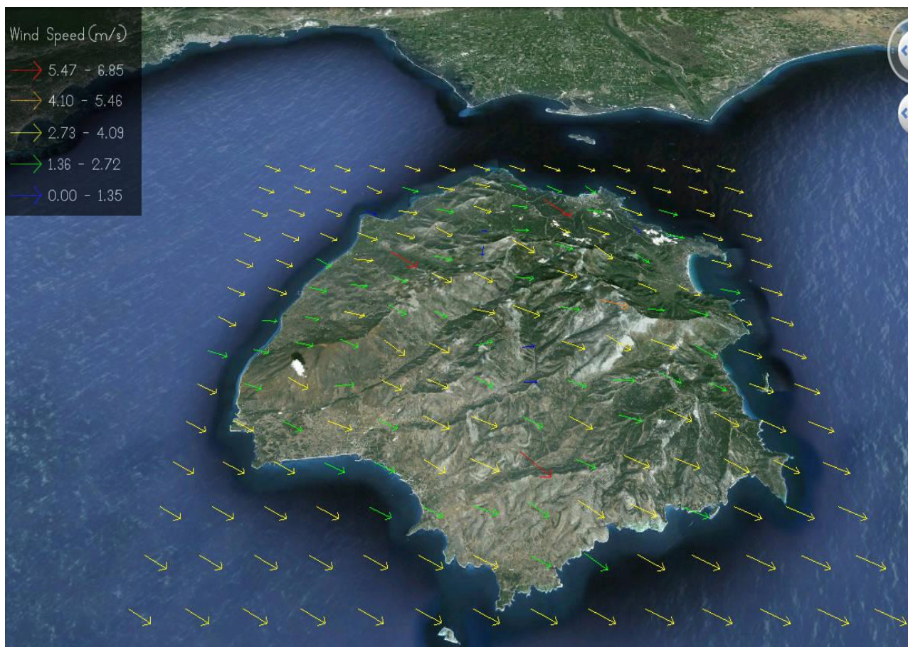
Εικόνα 3.6: Έξοδος του WNVisualization με χρήση χρώματος για την οπτική αναπαράσταση της έντασης του ανέμου, με κάθε βέλος να αντιστοιχεί σε περιοχή 50 κελιών και με χρήση του μηδενός σαν ελάχιστη τιμή στα όρια της κβάντισης
