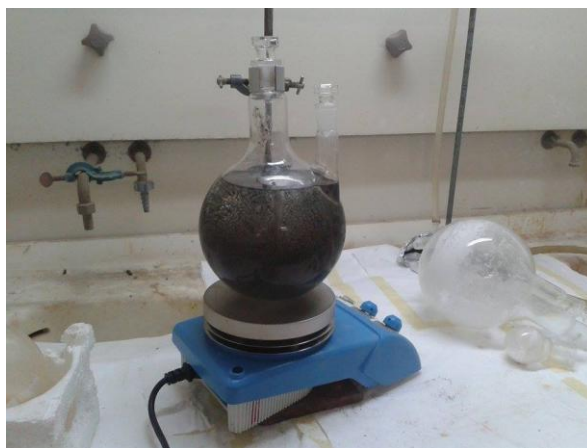
Εικόνα 16: Οξικός αιθυλεστέρας μετά από αντίδραση με πεντοξειδίο του φωσφόρου.
