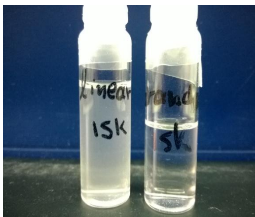
Εικόνα 35: Διάλυμα πολυμερούς με γραμμικό μακροαπαρχητή και διάλυμα πολυμερούς με διακλαδισμένο μακροαπαρχητή για μετρήσεις του DLS.
