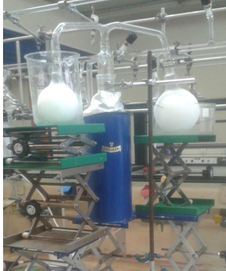
Εικόνα 25: Απομάκρυνση του H 2 O από το πολυμερές με την τεχνική freeze drying.
