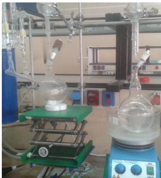
Εικόνα 20: Απόσταξη βενζολίου στη συσκευή πολυμερισμού που περιέχει PEO (εργαστήριο)
