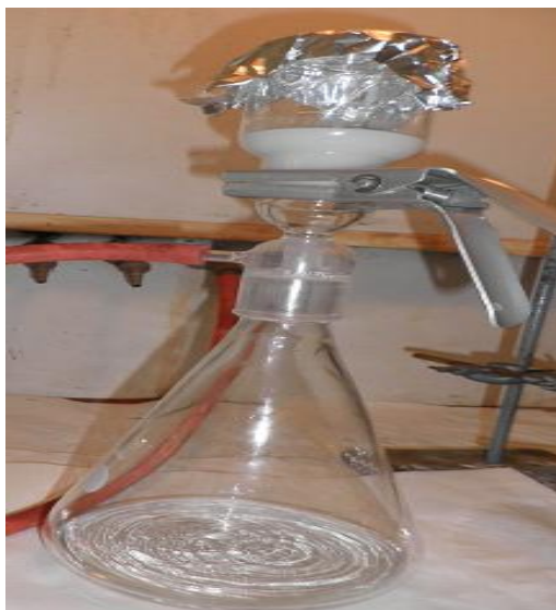
Εικόνα 23: Διήθηση του πολυμερούς στο χωνί Buchner
