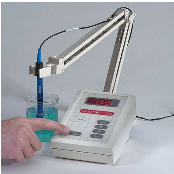
Εικ 27: Μετρητής pH Μοντέλο Consort P601
