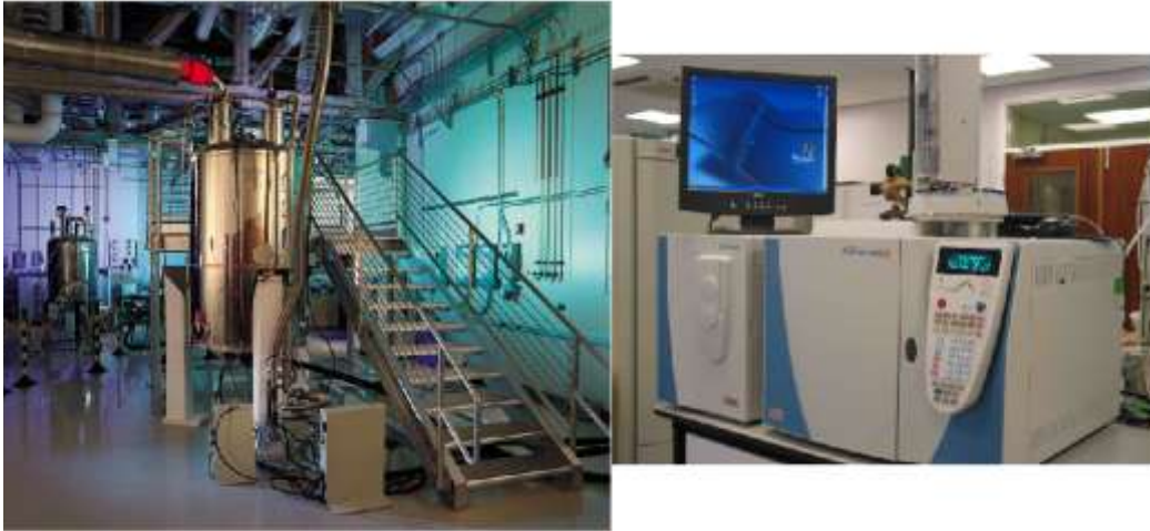
Εικ 25: Αριστερά: Φασματογράφος πυρηνικού μαγνητικού συντονισμού (NMR). Δεξιά: Φασματογράφος Μάζας (MS)
