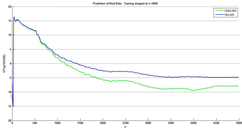
Σχήμα 3.4: Οι καμπύλες μάθησης (learning curves) του normalized KLMS εφαρμόζοντας κβαντισμό (QNKLMS) (μέγεθος κβάντισης \delta = 0.1 ) και το Platt's Novelty Criterion (NKLMS) ( \delta_1 = 0.04, \delta_2 = 0.04 ) για την αραίωση της λύσης. Το Μέσο Σχετικό Σφάλμα (Average Relative error) στην εκτίμηση των τιμών από τον QNKLMS για τα 50 τεστ είναι συνολικά: 4.8085% (Training: 4.7266%, Testing: 4.8392%), ενώ για τον NKLMS είναι συνολικά: 7.3752% (Training: 7.5749%, Testing: 6.8555%).
