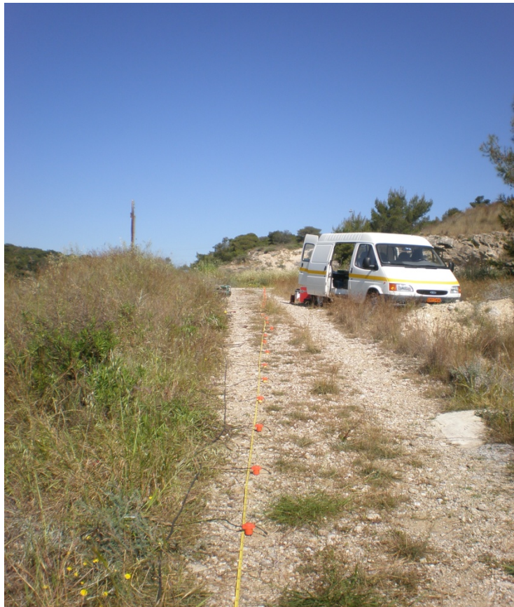
Εικόνα 6.5 – Κανονικό Ανάπτυσμα (Normal Spread): Οι πρώτοι 48 σεισμικοί δέκτες που τοποθετήθηκαν για την διαδικασία της ανάλυσης θορύβου.
