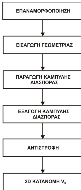
Εικόνα 9.3: Γράφημα ροής επεξεργασίας (processing flow) που ακολουθήθηκε στα δεδομένα επιφανειακών κυμάτων.
