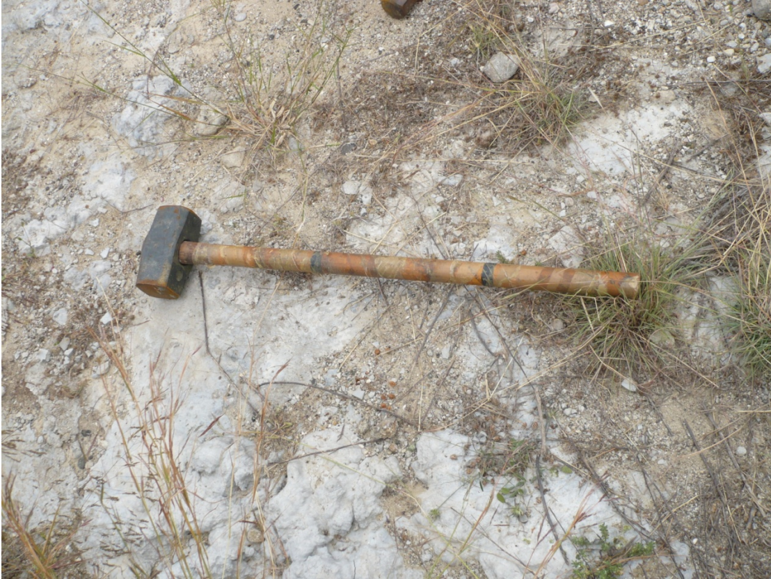
Εικόνα 6.7 – Σεισμικό σφυρί που χρησιμοποιήθηκε ως πηγή κατά την διεξαγωγή του πειράματος της ανάλυσης θορύβου (Noise Analysis).
