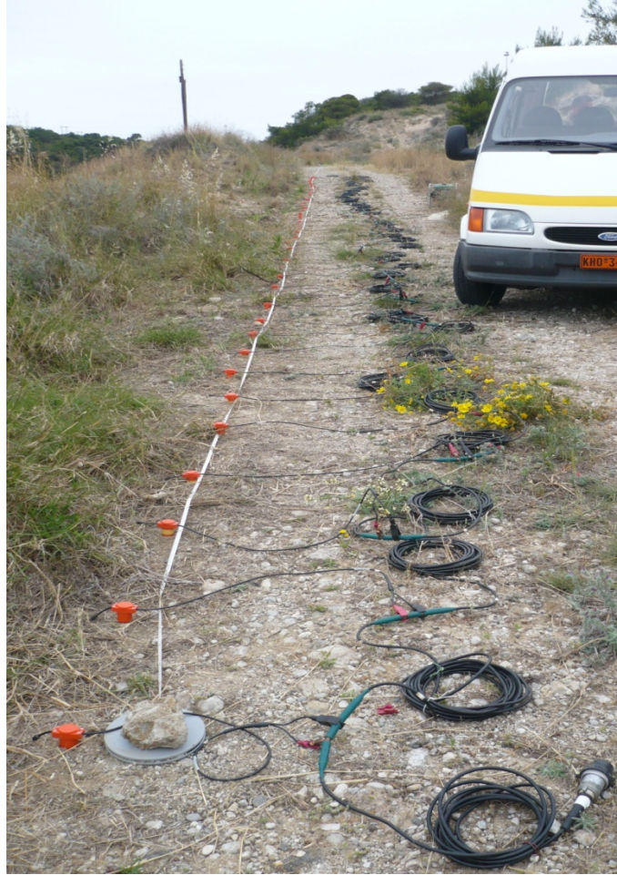
Εικόνα 8.2 : Σεισμική διάταξη που χρησιμοποιήθηκε κατά το στάδιο λήψης δεδομένων σεισμικής ανάκλασης. Η σεισμική γραμμή παρουσίασε συνολικό ανάπτυγμα περί τα 50.2 m. Τύπος πηγής: Σεισμικό σφυρί 5 Kg – Πλάκα σύζευξης 5 Kg διαμέτρου 10 cm.
