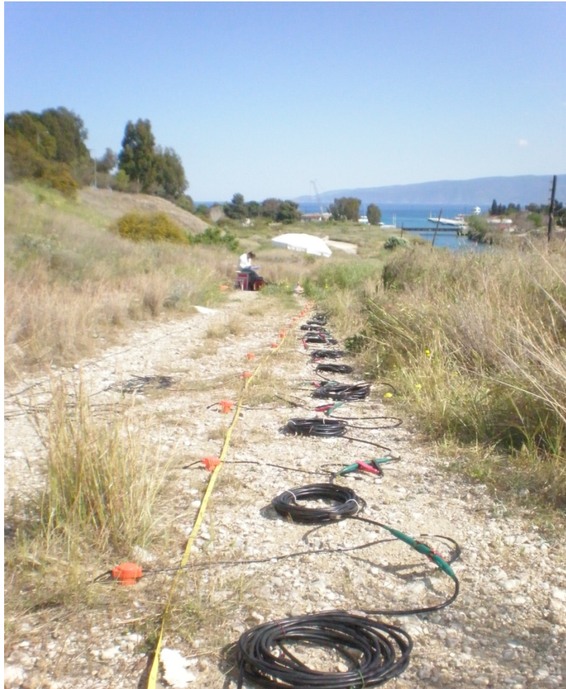
Εικόνα 6.6 – Κανονικό Ανάπτυγμα (Normal Spread): Η προέκταση του κανονικού αναπτύγματος κατά 24 m.
