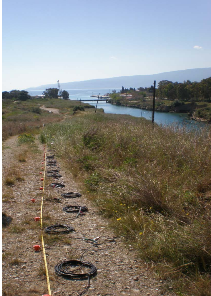
Εικόνα 9.2: Σεισμική διάταξη που χρησιμοποιήθηκε κατά το στάδιο λήψης δεδομένων επιφανειακών κυμάτων. Η σεισμική γραμμή παρουσίασε συνολικό ανάπτυγμα περί τα 52 m. Τύπος πηγής: Σεισμικό σφυρί 5 Kg – Πλάκα σύζευξης 5 Kg διαμέτρου 10 cm.
