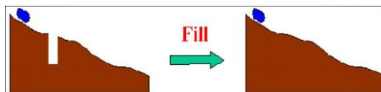
Σχήμα 14 : Απομάκρυνση κοιλωμάτων ενός ΨΜΕ με στόχο την καλύτερη αποτύπωση κίνησης της σταγόνας στην επιφάνεια του εδάφους (Πηγή: Maidment, 2002)
