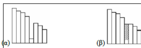
Σχήμα 13 : α) Προφίλ αρχικού dem που παρουσιάζει την τοπική ταπείνωση ενός κελιού, β) Προφίλ νέου dem (filled dem) στο οποίο οι χαμηλότερες τιμές στα κοιλά έχουν αντικατασταθεί από υψηλότερες. (Πηγή: Advanced GIS Workshop for UCCE, 2007)
