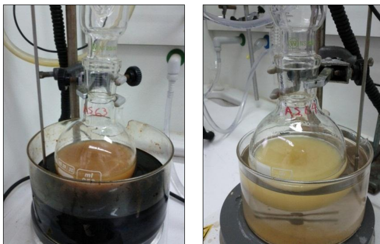
Εικόνα 2.1. Διαφορά στο χρώμα στην αντίδραση διμερισμού με χρήση ένυδρου και άνυδρου \text{AlCl}_3 .
