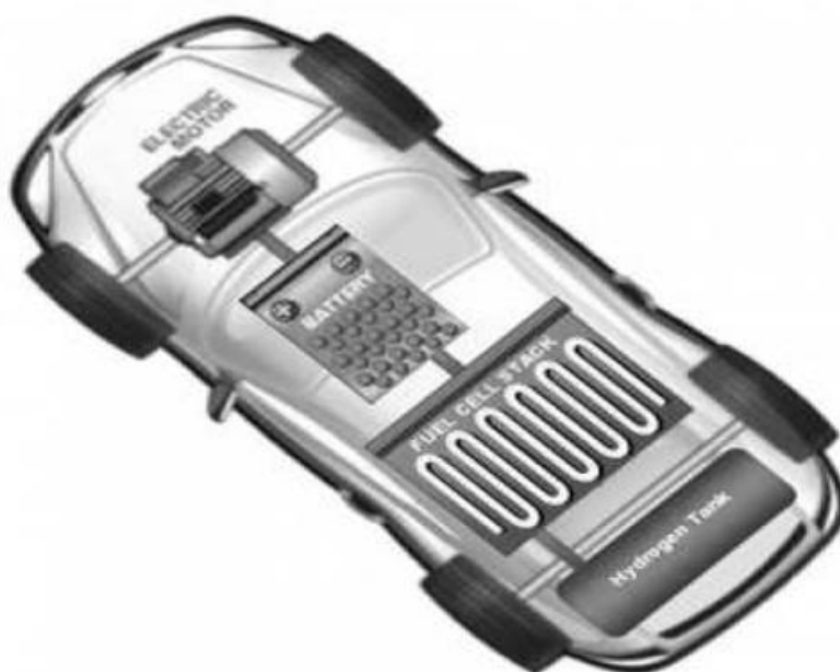
Εικόνα 7 : Κάτοψη οχήματος FCEV [19]
