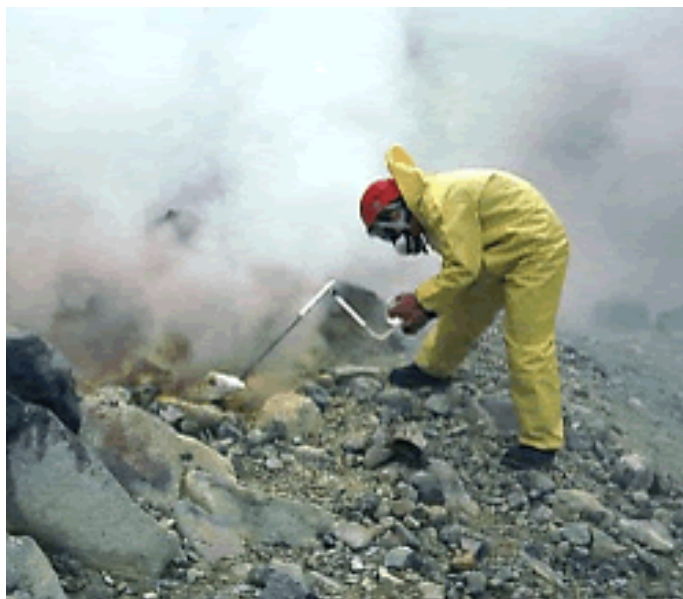
Εικόνα 53 Δειγματοληψία αερίων στο ηφαίστειο Mageik στην Αλάσκα. Το αέριο μεταφέρεται μέσα από μεταλλικό σωλήνα που έχει τοποθετηθεί μέσα σε μια φουμαρόλη και στην συνέχεια αναλύεται στο εργαστήριο (USGS).
