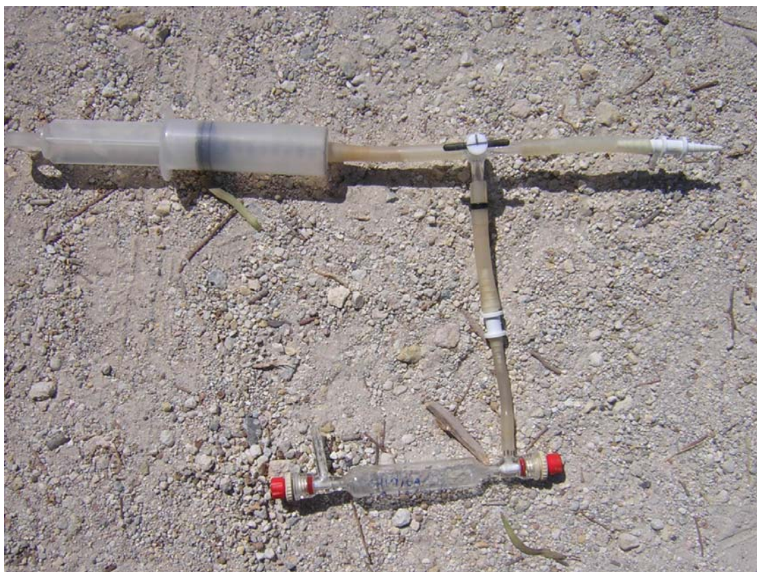
Εικόνα 49 Διάταξη οργάνων που χρησιμοποιήθηκαν για την λήψη δείγματος αέρα.
