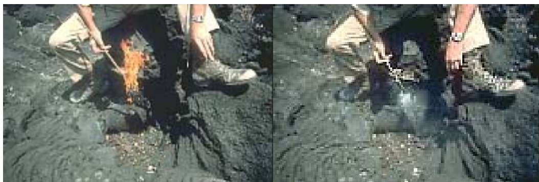
Εικόνα 40 CO 2 παγιδευμένο σε λάκκο μπορεί να είναι θανατηφόρο για τον άνθρωπο και τα ζώα (πηγή USGS).
