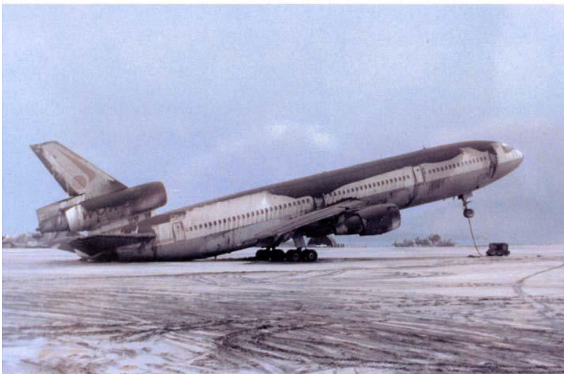
Εικόνα 40. DC-10 στο έδαφος καλυμμένο από ηφαιστειακή τέφρα στην Cubi Point Naval Air Station στις Φιλιππίνες. (Casadewall, 1993).
