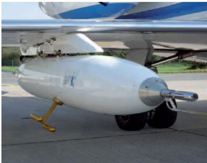
Εικόνα 35. Αερομεταφερόμενη μονάδα (κλασική επί τόπου δειγματοληψία- in situ ) (Berbente, 2011)
