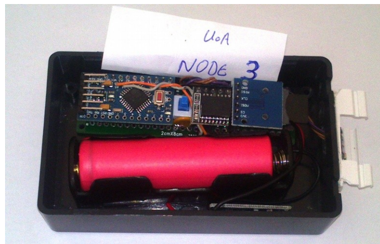
Σχήμα 4.17: Κόμβος καταγραφής μετεωρολογικών παραμέτρων.
