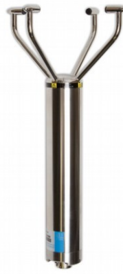
Σχήμα 3.7: Το WindObserver 75 της Gill Instruments
