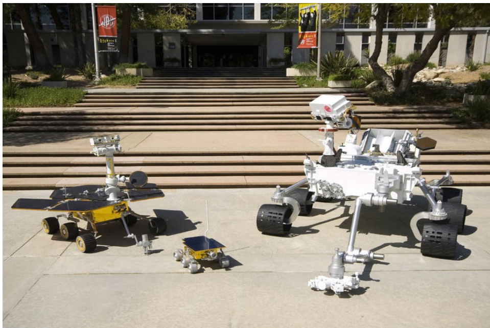
Εικόνα 2.1.17. Σύγκριση μεγέθους μεταξύ του Mars Science Laboratory (δεξιά), του Mars Exploration Rover (αριστερά) και του Sojourner Rover (κέντρο). Η φωτογραφία πάρθηκε από το Jet Propulsion Laboratory.
