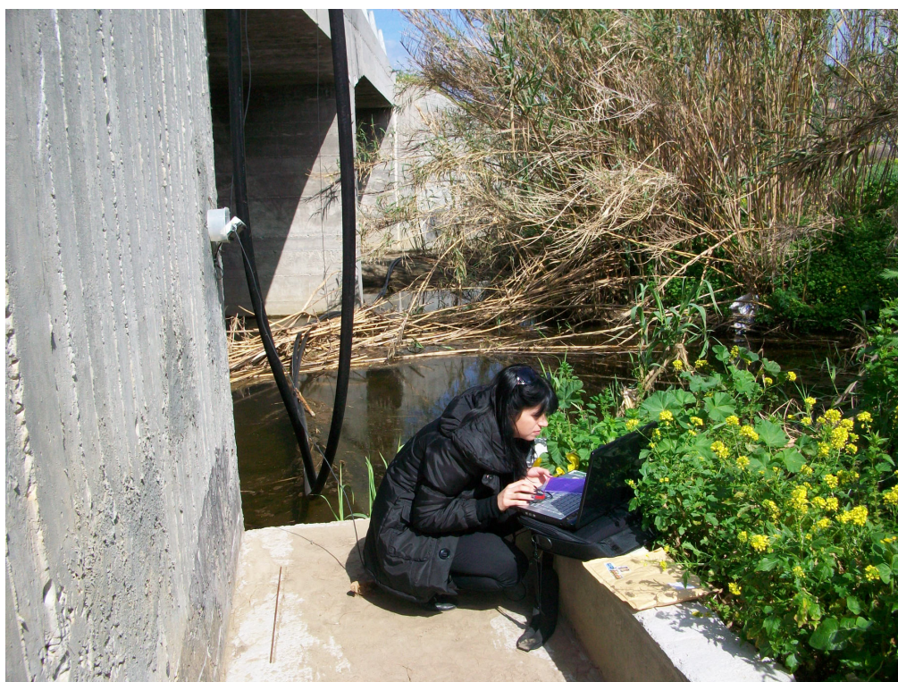
Εικόνα 31. Μεταφορά δεδομένων από το σταθμήμετρο (2011).
