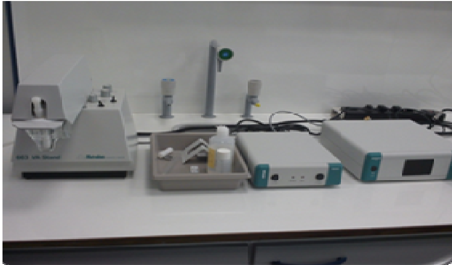
Εικόνα 7.1 Ηλεκτροχημικός αναλυτής ECO-CHEMIE συνδεδεμένος με κυψελίδα μέτρησης τριών ηλεκτροδίων της Metrohm (VA 663)
