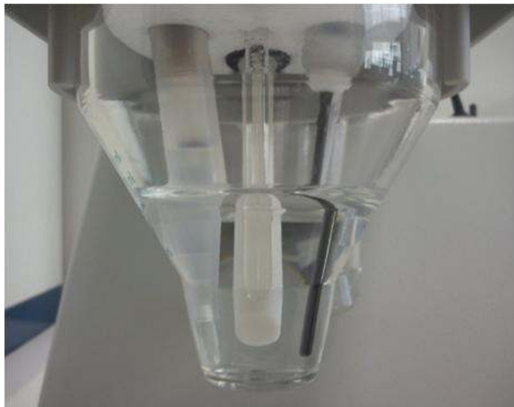
Εικόνα 7.2 Κυψελίδα μέτρησης του ηλεκτροχημικού αναλυτή μαζί με τα ηλεκτρόδια
