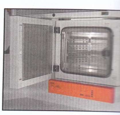
Εικόνα 1.4 : Ο ειδικός φούρνος βαθμονόμησης (WTC BINDER 78532).
