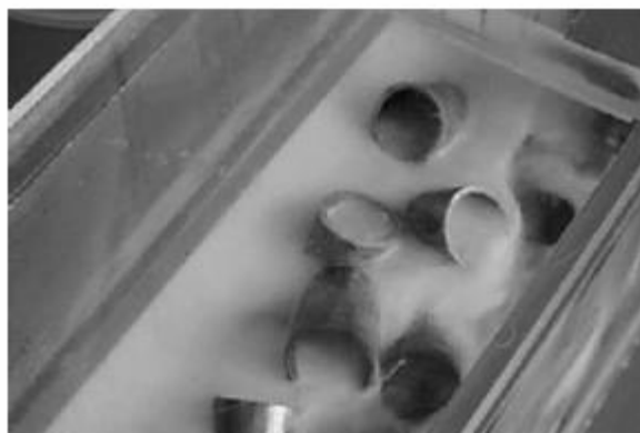
Εικόνα 4.4 : Βελτίωση μετάδοσης θερμότητας με προσθήκη κομματιών χαλκού.
