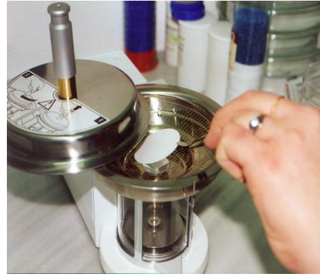
Εικόνες 3.2 και 3.3: Ειδικός διαμορφωμένος χώρος ζύγισης και συνθηκοποίησης των φίλτρων – αναλυτικός ζυγός ακριβείας 10^{-6} gr (METTLER TOLEDO)
