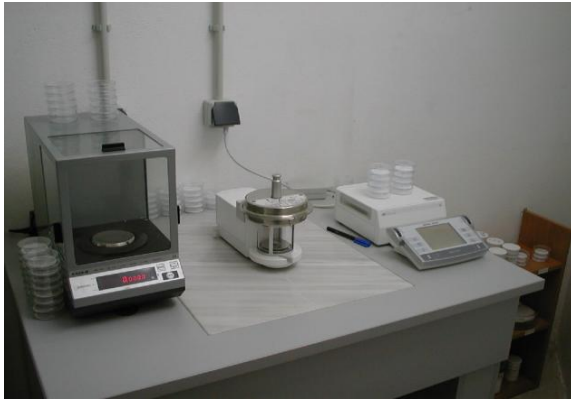
Εικόνες 3.2 και 3.3: Ειδικός διαμορφωμένος χώρος ζύγισης και συνθηκοποίησης των φίλτρων – αναλυτικός ζυγός ακριβείας 10^{-6} gr (METTLER TOLEDO)
