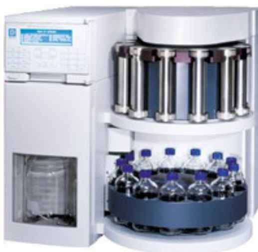
Εικόνα 3: Υγρή εκχύλιση υψηλής πίεσης (Accelerated Solvent Extractor, ASE 300) [221]
