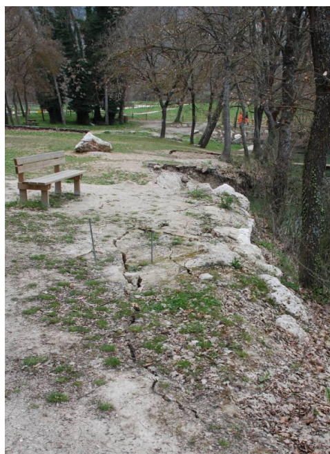
Φωτογραφίες 6.37 και 6.38: Αύξηση του εύρους της εδαφικής μετατόπισης στις όχθες της λίμνης Sinizzo. Οι Φωτογραφίες έχουν διαφορά 5 ημέρες (πηγή: G.E.E.R., 2009)
