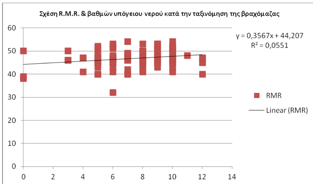
Σχήμα 6-29 Σχέση R.M.R. & βαθμών υπόγειου νερού κατά την ταξινόμηση της βραχώμαζας κατά Bieniawski, 1979
