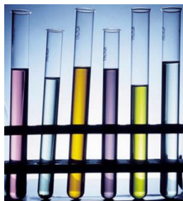
Εικόνα 3. Το υγρό δεν πρέπει να ξεπερνάει τα 2/3 του δοκιμαστικού σωλήνα
