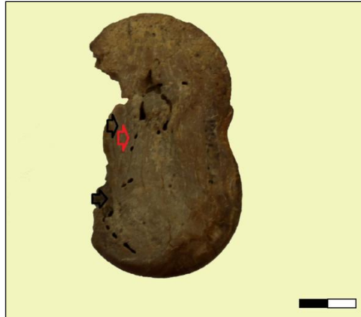
Εικόνα 2.15: Δείγμα 120P32A και σημεία λήψης δείγματος για XRD, SEM στην εσωτερική όψη αυτού.
