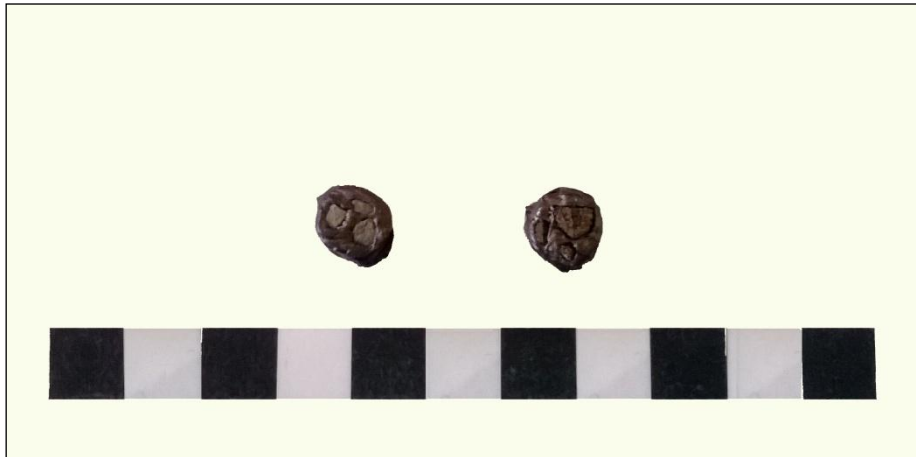
Εικόνα 2.25: Θραύσματα δύο δειγμάτων τοποθετημένα σε βάσεις με αγώγιμη πλαστελίνη, για ποιοτική παρατήρηση και ανάλυση στο SEM-EDS.
