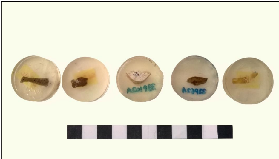
Εικόνα 2.26: Αντιπροσωπευτικές στιλπνές τομές των δειγμάτων μας, οι οποίες αναλύθηκαν ποσοτικά με τον ηλεκτρονικό μικροαναλυτή (microprobe).
