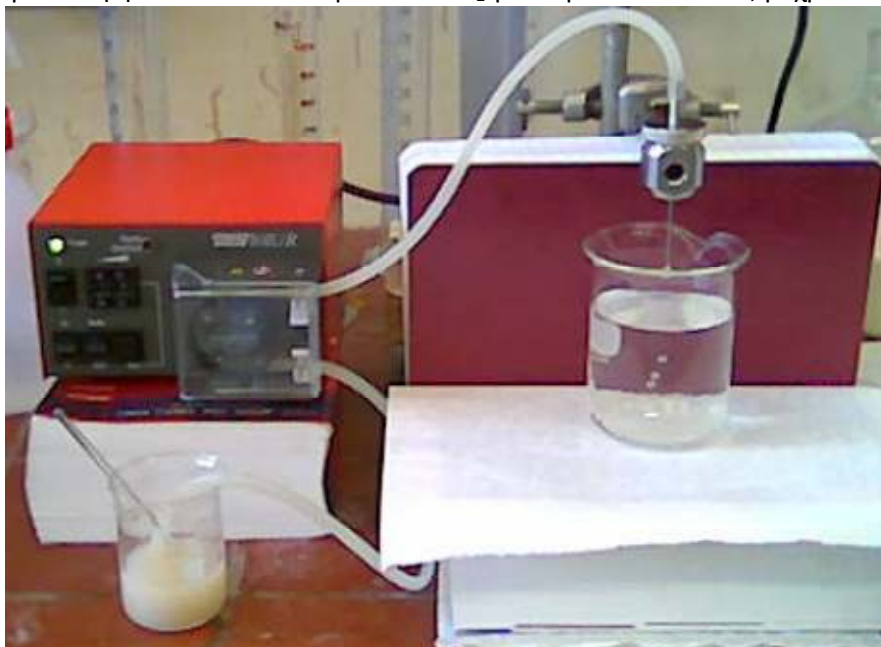
Η πειραματική διάταξη της κατασκευής των σφαιριδίων απλής στιβάδας.
