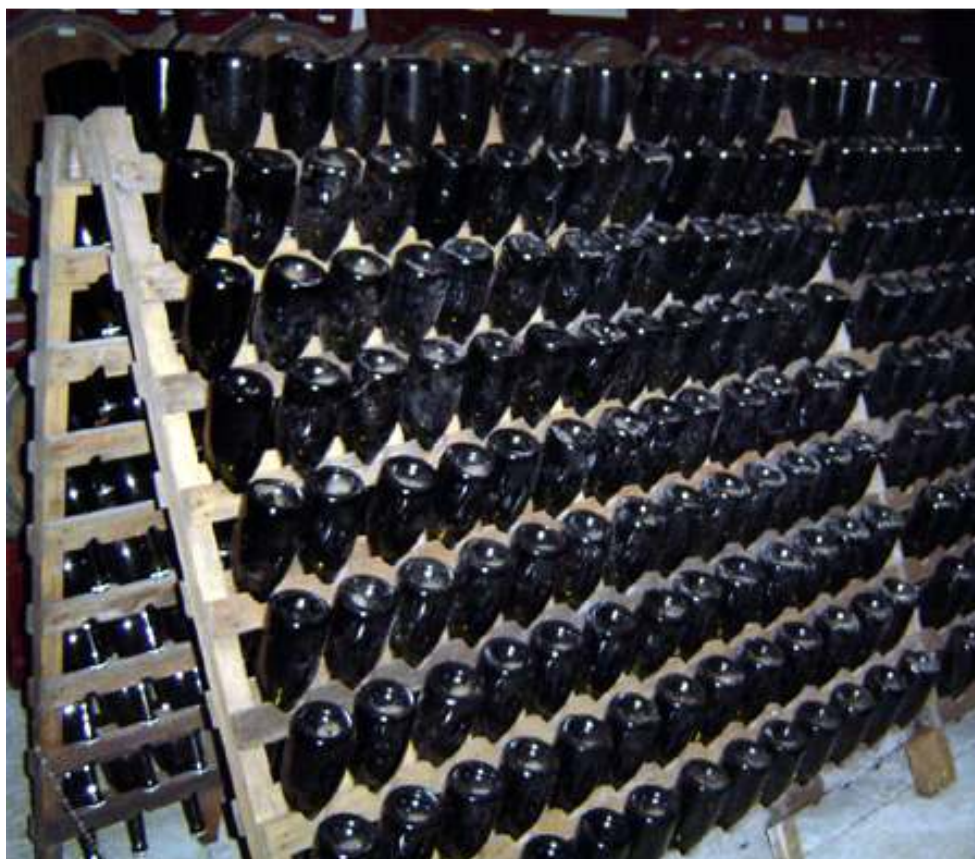
Εικόνα 5. Ειδικά αναλόγια για την διευκόλυνση απομάκρυνσης τους ιζήματος από τη φιάλη
