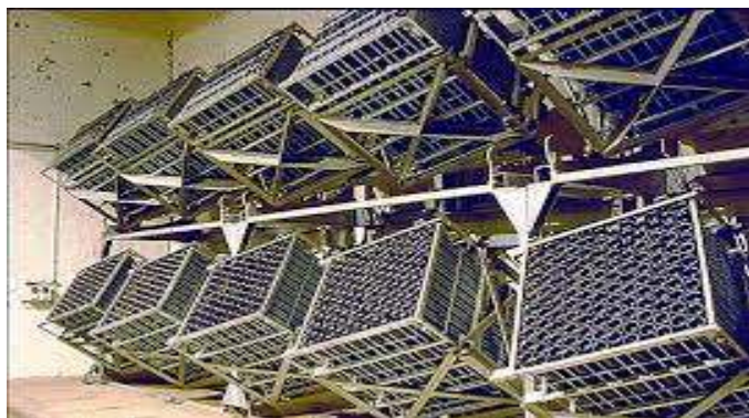
Εικόνα 6. Οι λεγόμενες γυροπαλέτες, που αυτοματοποιούν την απομάκρυνση του ιζήματος
