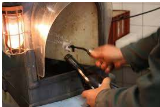
Εικόνα 8. Παραδοσιακός τρόπος εκπωματισμού στον αέρα για απομάκρυνση ιζήματος
