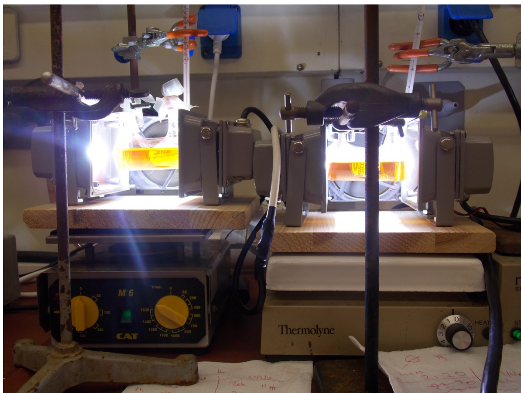
Εικόνα 1.1.2: Πειραματική διάταξη συστήματος [\text{Ni}(\text{dpedt})(\text{mnt})]^- (\text{TBA})^+ / \text{Ru}(\text{bpy})_3\text{Cl}_2 \cdot 6 \cdot \text{H}_2\text{O} / \text{L-ascobic acid} / \text{MeCN}:\text{H}_2\text{O}
