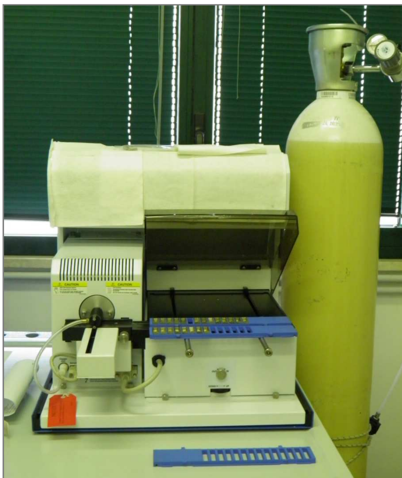
Εικόνα 2.17.: Όργανο SMS 100 Solid Mercury Analysis Systems με φιάλη οξυγόνου (Φωτογραφία: Οκτώβρης 2013)
