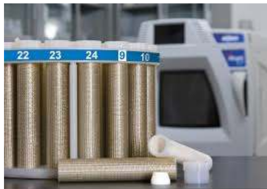
Εικόνα 7. Δοχεία Teflon, ρότορας, φούρνου μικροκυμάτων (microwave)
