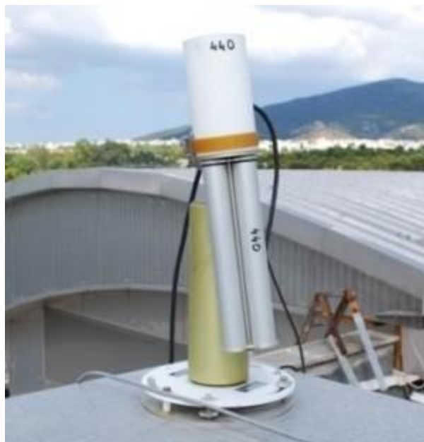
Εικόνα 8: Φωτόμετρο CIMEL CE318 [Πείραμα CHARADMExp]
