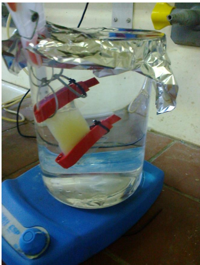
Εικόνα 19: Dialysis σε μεμβράνη με 3500 MB cut off
