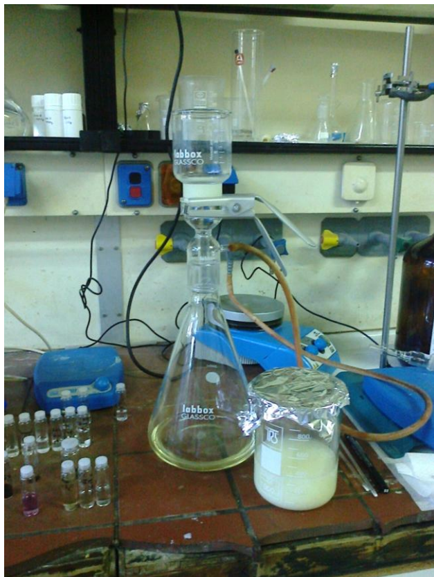
Εικόνα 17: Διήθηση του πολυμερούς στο χωνί Buchner.
