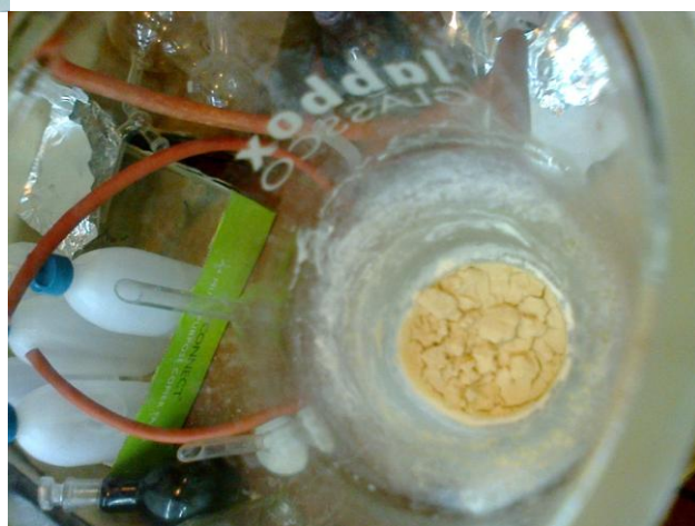
Εικόνα 18: Διήθηση στο χωνί Buchner.
