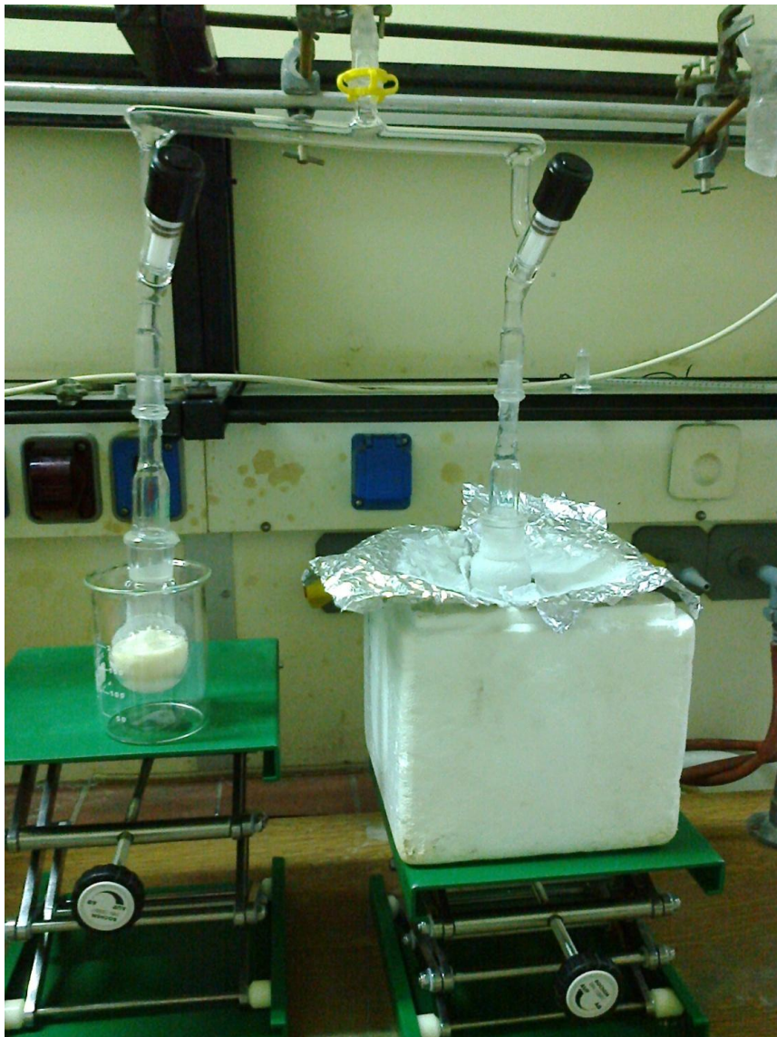
Εικόνα 20: Απομάκρυνση του H_2O , από το πολυμερές με την τεχνική του freeze drying.
