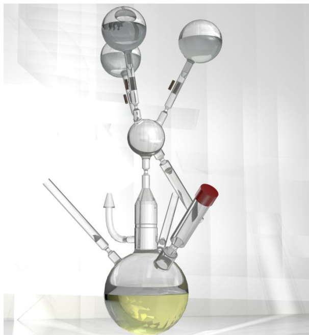
Εικόνα 2.1 Συσκευή ανακρυστάλλωσης-καθαρισμού των NCA's με την τεχνική υψηλού κενού.
