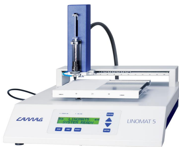
Εικόνα 7.1. Εξοπλισμός απόθεσης αντιδραστηρίων σε πλάκες (TLC). [46]
