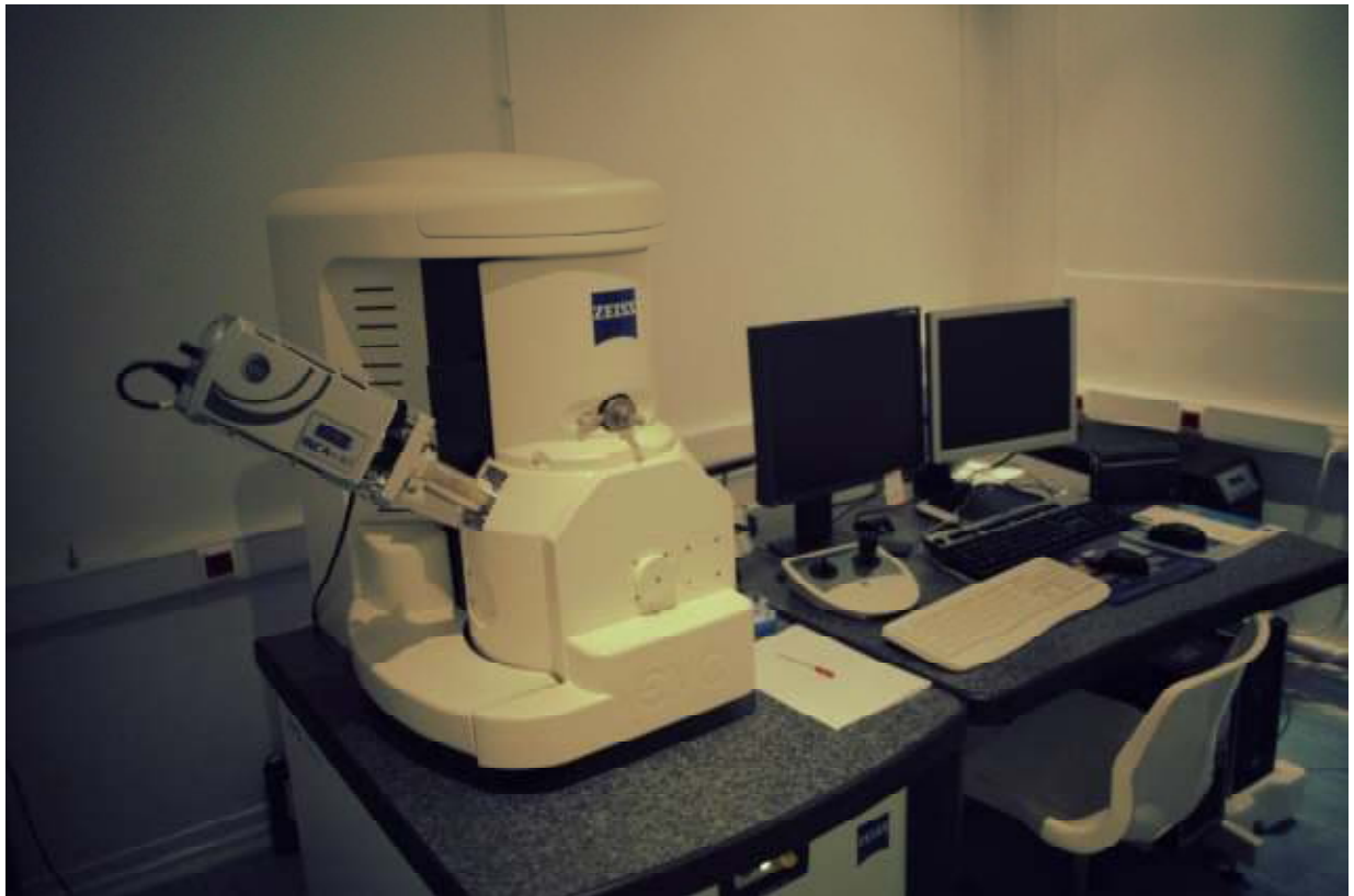
Εικόνα 3.11: Ηλεκτρονικό μικροσκόπιο σάρωσης ZEISS EVO MA 10, Εργαστήριο Τμήματος Επιστήμης των Υλικών.
