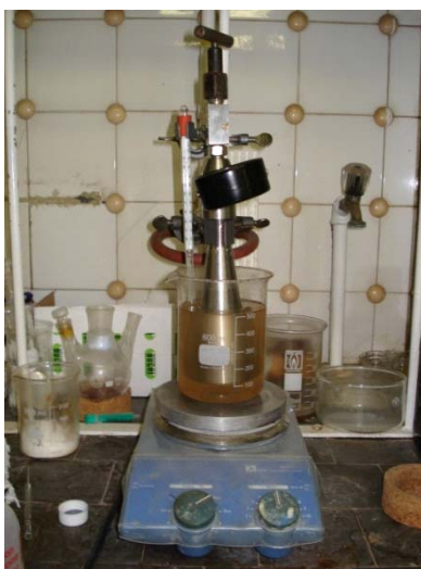
Εικόνα 30. Η διάταξη με την οποία πραγματοποιήθηκε η αντίδραση υδροαλκοξυκαρβονυλίωσης.
