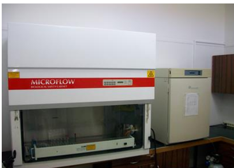
Εικόνα 1: Εικόνα από το χώρο καλλιιεργειών. Διακρίνονται ο θάλαμος νηματικής ροής και ο κλίβανος καλλιιεργειών.
