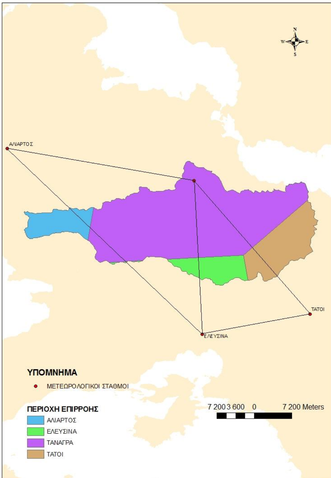
ΣΧΗΜΑ 4.1: Πολύγωνα THIESSEN και περιοχές επιρροής κάθε βροχομετρικού σταθμού στη λεκάνη απορροής του Βοιωτικού Ασωπού. Με διαφορετικό χρώμα απεικονίζονται οι επιμέρους περιοχές επιρροής. Το ύψος βροχής που μετρήθηκε σε κάθε βροχομετρικό σταθμό θεωρείται ότι είναι το ύψος βροχής που έπεσε στο πολύγωνο που το περιβάλλει.
