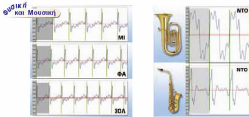
Σχήμα 1.4: Νότες και Φυσική: εικόνες στην οθόνη του παλμογράφου (α) Από διαφορετικές νότες που προέρχονται από το ίδιο όργανο. (β) Της ίδιας νότας που προέρχεται από διαφορετικά μουσικά όργανα.
